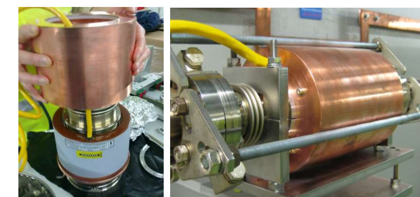
Transformador de corrent abans d'instal·lar (esquerra) i un cop instal·lat (dreta) a la cambra de buit.
